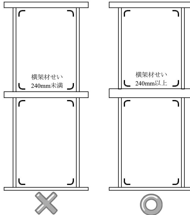
解説図 12 ユニットの上下連続配置 (横架材のせい 240mm 以上)
